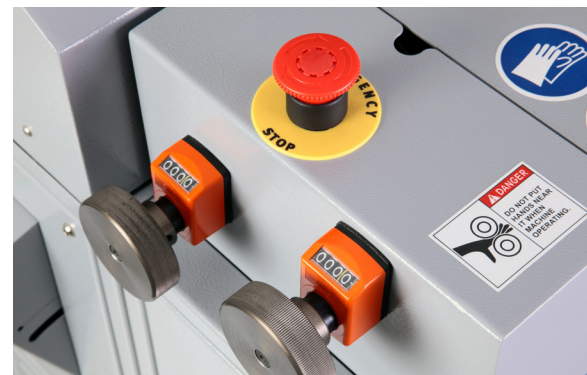
El Auto Gap/Separación Automática de Rodillos previene exceso de barniz que manche. Las perillas de calibración pueden ser ajustadas en intervalos de 0.1mm.
