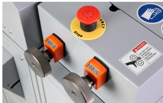
Las perillas permiten ajustar los rodillos de recubrimiento de manera fácil en incrementos de 0.1 mm
