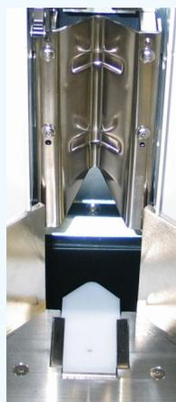
Diseño patentado de dados superior e inferior micro ajustable permite un corte suave y preciso
