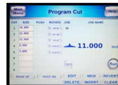
Una vez completado cada corte, el panel de la pantalla táctil le preguntará en qué dirección girar la pila para evitar errores de corte.
