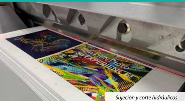
Sujeción y corte hidráulicos
