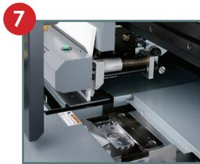
**7 ESTACIÓN DE ENGOMADO** La preparación precisa del lomo se hace con un fuerte fresado de dos navajas que pueden cortar las hojas del libro y pequeños bloques doblados.
