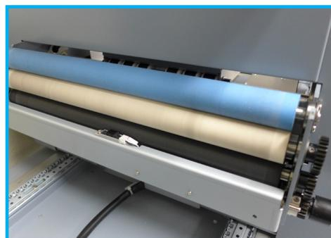
*Los rodillos anti polvo y de reductor de bucle mantienen planas las hojas*
