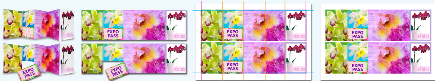
piezas terminadas ← tarjeta de respuesta o cupón perforado ← refilado, corte, hendido, perforado, y perforado en cruz en un solo paso ← aplicación ejemplar
