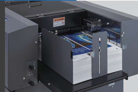
Sistema de alimentación por succión de aire
