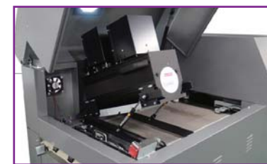
La lámpara UV cura instantáneamente el barniz UV aplicado
